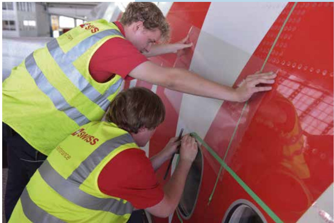
Mise en place du film aeroSHARK © SWISS
